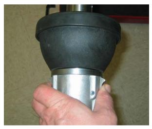
Для снятия устройства авто-зажима слегка *дважды* нажмите на ножную педаль для деактивации пневмомеханизма. Нажмите на язычки устройства автозажима и снимите его с вала.
