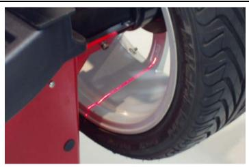
При включенной функции сервоостановки прикрепите приклеиваемый груз отображаемого на ЖК-дисплее номинала для левой грузовой плоскости. Смотрите раздел «Размещение приклеиваемого груза с помощью функции серво-стопа». Если функция серво-стопа выключена, размещение груза следует производить в НМТ. Смотрите раздел «Измерение места установки грузов вручную».
