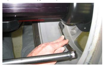
Возможно сканирование диска с кромки обода или изнутри обода. Расположите внутренний измерительный рычаг на внутренней части обода и **нажмите и удерживайте** педаль. Экран сканироования диска появится автоматически.
