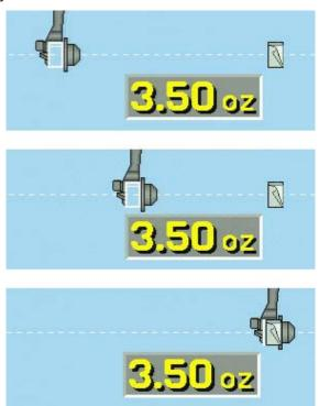
Сохраняя эту дистанцию, поверните измерительный рычаг к внутренней поверхности обода, а затем нанесите приклеиваемые грузы на обод.
