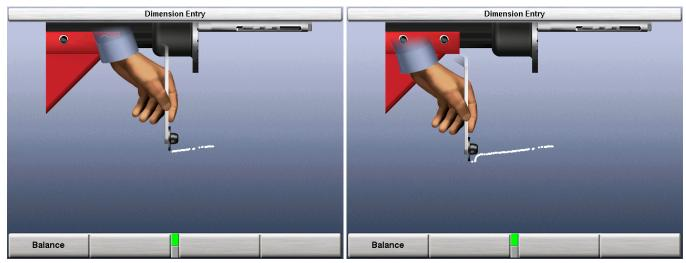
При окончании сканирования, отпустите ножную педаль и повится вид диска с расположенными автоматически грузами а зависимости от внутреннего наклона и изгибов диска.
