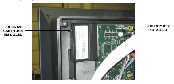
Вставьте электронный ключ безопасности в нижнее гнездо на плате узла суппора.
