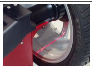
При включенной функции серво-стопа прикрепите приклеиваемый груз отображаемого на ЖК-дисплее веса для правой грузовой плоскости. Смотрите раздел «Размещение приклеиваемого груза с помощью функции сервоостановки». Если функция серво-стопа выключена, размещение груза следует производить в НМТ. Смотрите раздел «Измерение места установки грузов вручную».
