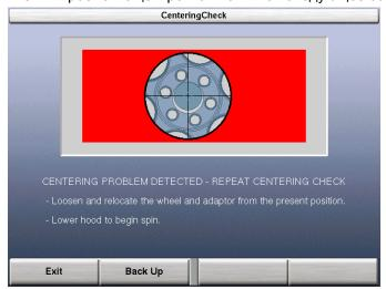
Повторная проверка качества центровки будет выполнена четыре раза, при этом данные, полученные от последующей проверки, будут сравниваться с данными, полученными от предыдущей проверки. Если после четырех попыток центровки достичь не удастся, на экране появится следующее сообщение:
