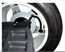
ПРИМЕЧАНИЕ: Если функция сервоостановки выключена (но при этом активирована в настройках), нажатие кнопки «START» при поднятом защитном кожухе включит функцию сервоостановки для нанесения приклеиваемого груза.
